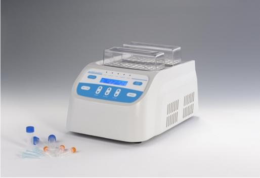
**产品介绍:** 干式恒温器是一款基于薄膜加热与 PID 自动控温技术设计的样品恒温孵育设备。灵活的定时、恒温及双区独立控温技术可有效的提高实验室工作效率，是各类样品孵化、催化以及保存等反应过程理想的设备。
