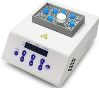
**基本介绍:** 珠浴恒温器（恒温金属珠浴）创新设计,不同于传统的金属浴和水(油)浴,此款新型恒温金属护甲珠浴的组成模块采用最新推出的 Beads Block (护甲珠浴模块),既突破了水浴沸点(100℃)的上限,又避免了传统金属浴模块孔径的局限性,适用于多种常规的实验室容器,如离心管、试管、微孔板和载玻片,并能适应任意形状和体积的试管。恒温金属珠浴可提供最佳的温度均匀性和准确性。紧凑轻便的护甲珠浴模块设计减少了常规金属浴中对不同尺寸模块的需求。
